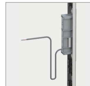
RIEGELSCHALTCONTACT RSK2 Im obere Schließblech eingebaut. Wird durch den Schwenkriegel des Türschlosses betätigt. Rückmeldung: Tür manuel oder mechanisch abgeschlossen!
